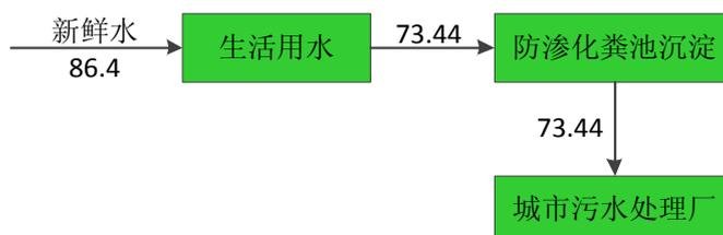
图 2.4-1 水平衡图（单位：m<sup>3</sup>/d）
