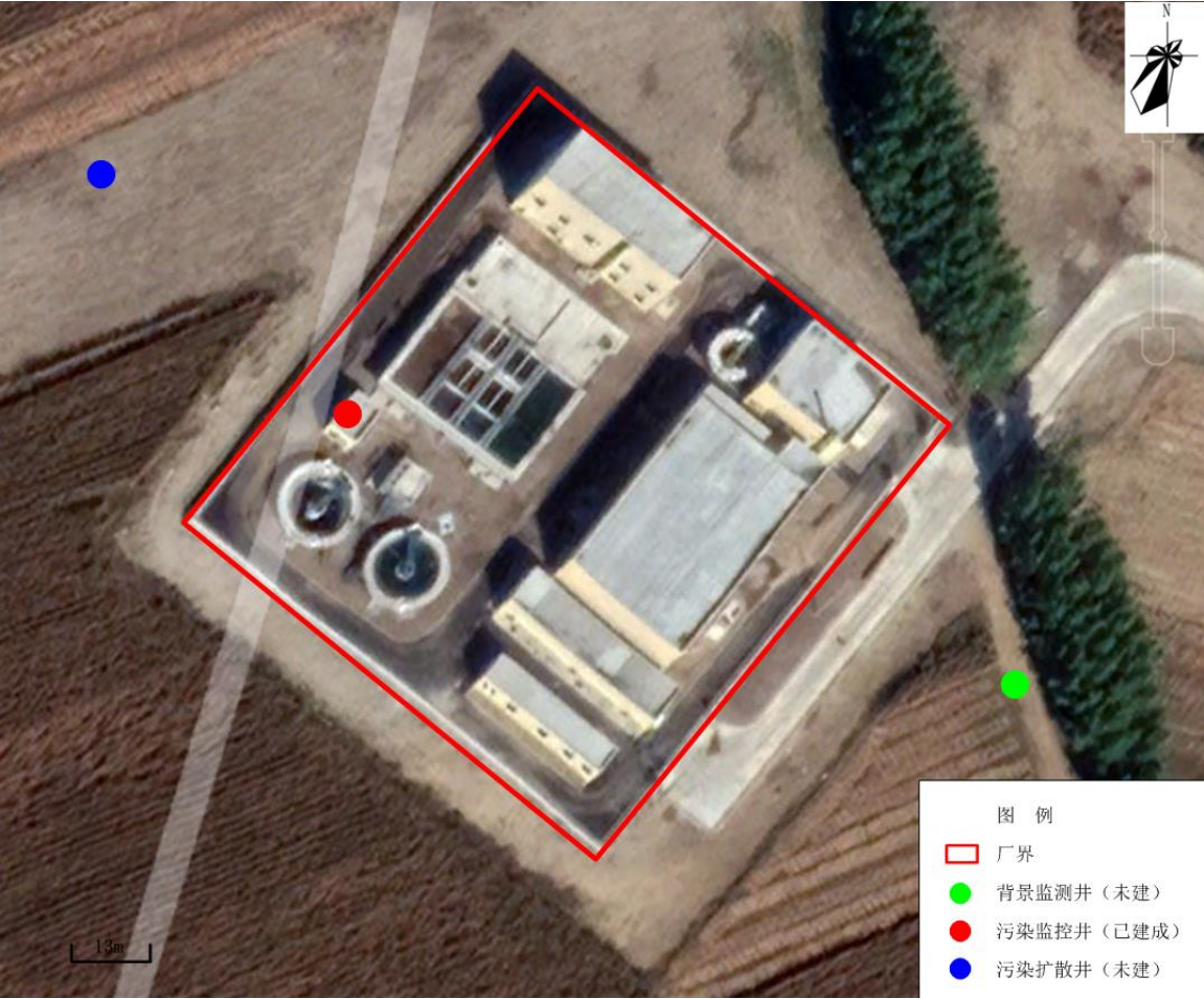
图 5-7 建设项目地下水监测井布设图
