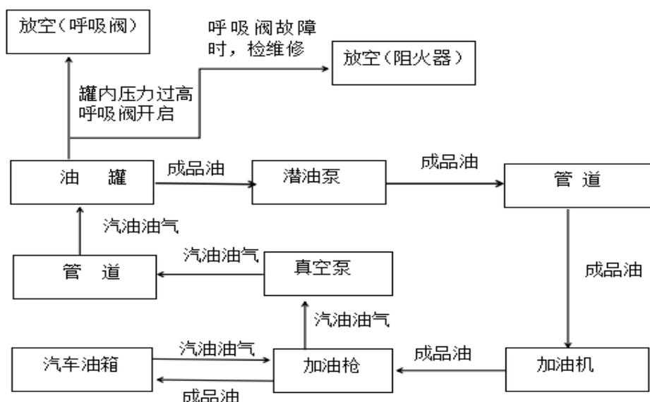
图 2-4 汽油加油及油气回收工艺流程图
