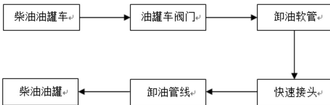
图 2-3 柴油卸油流程图
