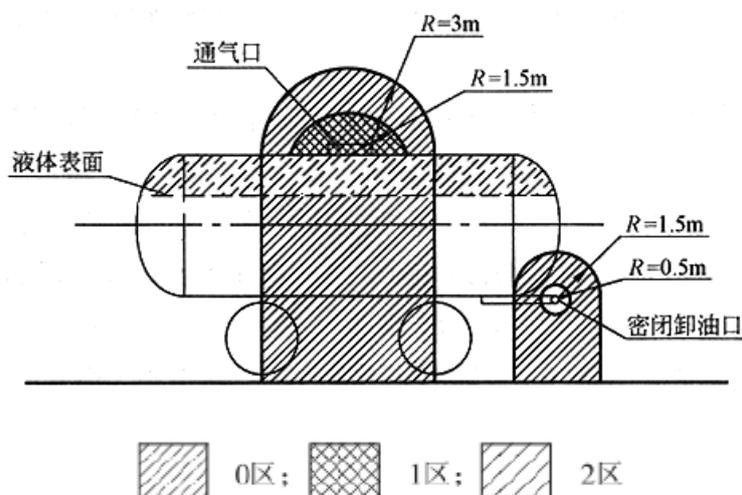
图 3-2 油罐车卸汽油时爆炸危险区域划分
