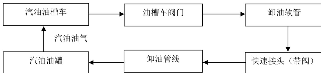
图 2-2 汽油卸油流程图
