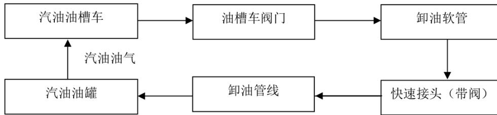
图 2-2 汽油卸油流程图
